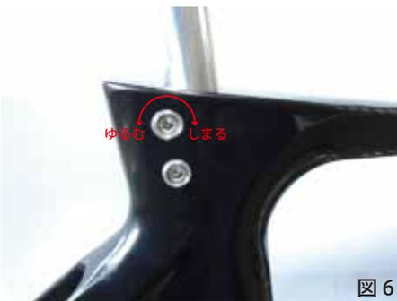
シートポストをシートポスト取付け穴に差し込みます。シートポストの位置が決まったら、シートバインダーボルト（2本）を図7のようにTハンドル六角レンチ5mmを使用して締め付け、シートポストを固定します。
