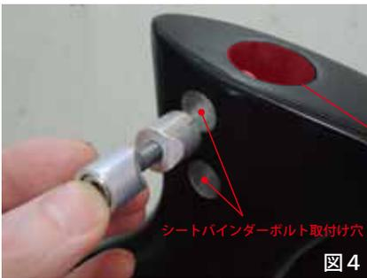
フレームのシートバインダーボルト取付け穴にセット（差し込み）します。
