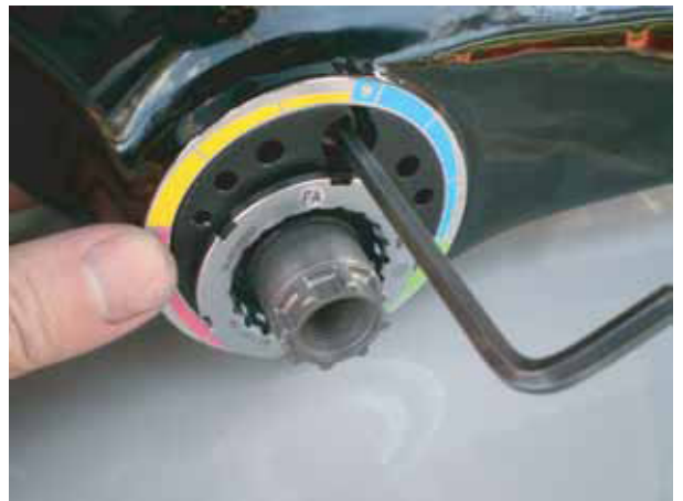
④偏心シェルは左側からのみ六角レンチで調整可能です。時計回転で締付け機構が働きフレームに取付できます。反時計回転で緩みます。
