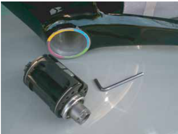
③ボトムブラケットと偏心シェルとフレームおよび六角レンチ（４ミリ）
