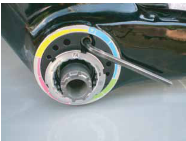
⑤偏心シェルを固定後、ボトムブラケットを従来のフレームと同様に締付け・調整を行います。シェルの固定はこのときほどほどでOKです。←ご注意ください。
