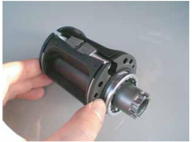
②偏心シェルにボトムブラケットを仮止めします。この時フレームにはセットしません。
